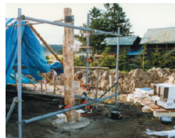
写真 8 埋め込み構法柱の水平加力試験
