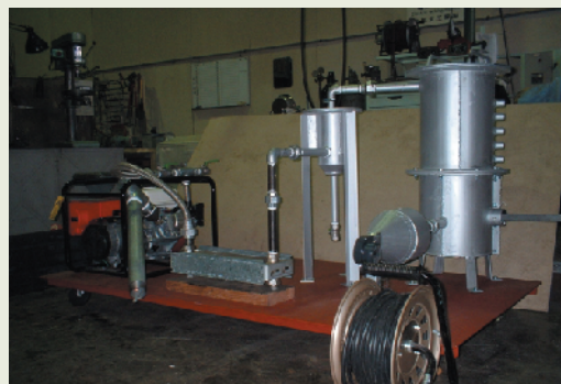
試作したガス発電装置
