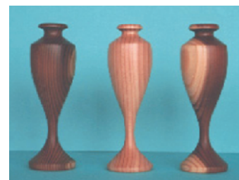
写真 3 アンモニアによるカラマツ材色の変化
