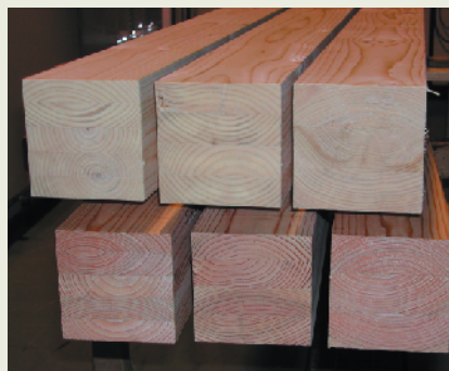
管柱：左から 5層、4層、3層
