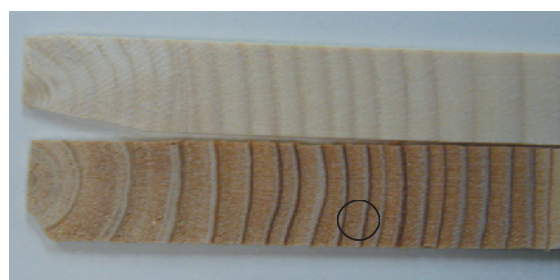
写真 4 木材の年輪構造 上：トドマツ，下：カラマツ
