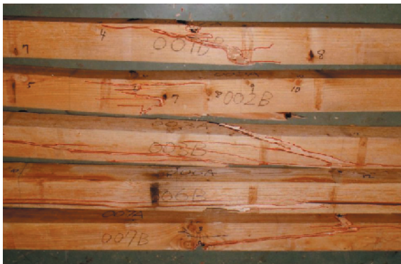
写真 1 実大材の曲げ試験の様子 (上) と 破壊形態 (下)
