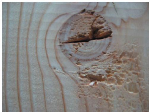
写真 2 節の欠けとさか目ぼれ
